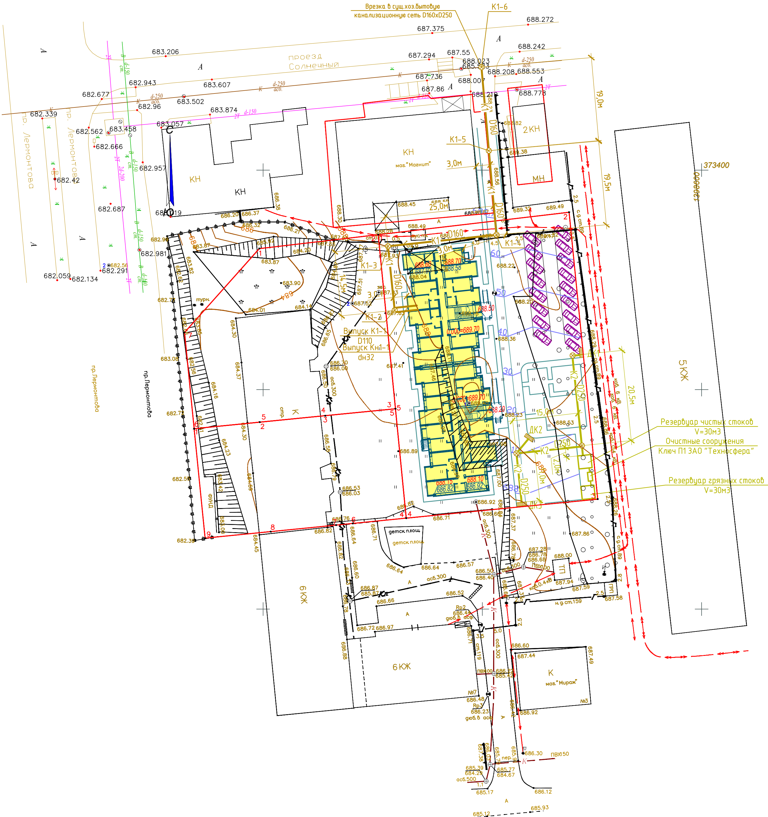
План участка с сетями водоотведения М1:500
